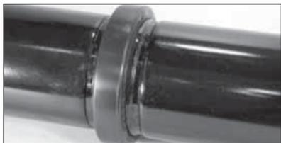
**4. ROHRENDEN VERBINDEN:** Fluchten Sie die beiden Rohrenden aus und führen Sie sie zusammen. Führen Sie das andere Rohr in die Dichtung ein, bis es den Mittelsteg der Dichtung berührt. **ANMERKUNG:** Stellen Sie sicher, dass kein Teil der Dichtung in die Nut an den Rohrenden reicht.
