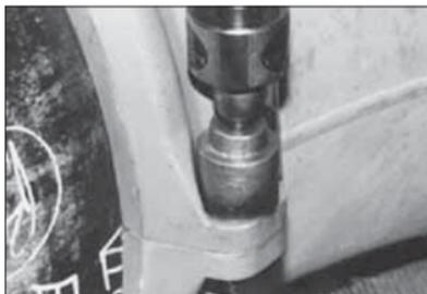
**4. MUTTERN FESTZIEHEN:** Ziehen Sie alle Muttern gleichmäßig über Kreuz fest, bis an den Passflächen Metall auf Metall trifft. Stellen Sie sicher, dass die Federn der Gehäusehälften vollständig in die Nuten eingreifen. **ANMERKUNG:** Es ist wichtig, alle Muttern gleichmäßig festzuziehen, um ein Einklemmen der Dichtung zu verhindern.
