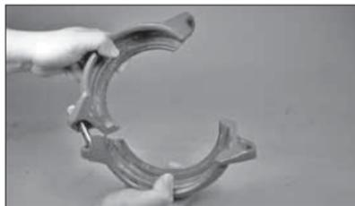
6. **ERLEICHTERUNG DER ERNEUTEN MONTAGE:** Eine Schraube kann in die Gehäusehälften eingeführt und die Mutter lose auf die Schraube gefädelt werden, damit die „Schwenkfunktion“, wie oben gezeigt, ermöglicht wird. **ANMERKUNG:** Die Mutter sollte nicht weiter rückwärts gedreht werden als bündig mit dem Schraubenende.
