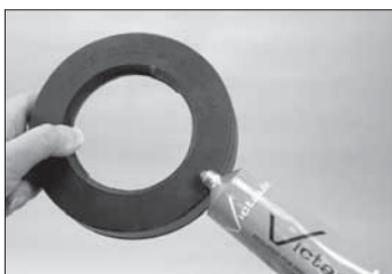
**2. DICHTUNG ÜBERPRÜFEN UND SCHMIEREN:**
