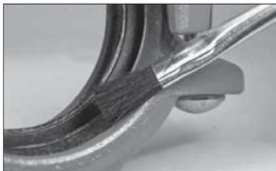
**4. DICHTUNG SCHMIEREN:** Eine dünne Schicht Victaulic Schmiermittel oder Silikon-Schmiermittel auf die Dichtungslippe auftragen. **ANMERKUNG:** Die Dichtung ist werksseitig außen mit einem Schmiermittel versehen, d.h., die Dichtung muss nicht aus dem Gehäuse genommen werden, um zusätzliches Schmiermittel aufzutragen.
