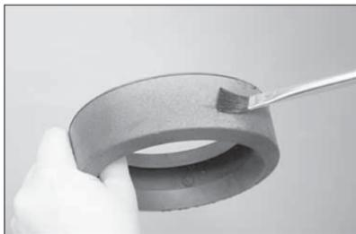
**3. DICHTUNG ÜBERPRÜFEN UND SCHMIEREN:** Die Dichtung prüfen und sicherstellen, dass sie für die beabsichtigte Anwendung geeignet ist. Die Dichtungsklasse wird durch den Farbcode angegeben. Eine dünne Schicht Victaulic Schmiermittel oder Silikonschmiermittel auf die Dichtungslippen und das Äußere der Dichtung auftragen.
