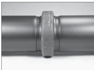
5. **ROHR/ANSCHLUSSTEILE VERBINDEN:** Die beiden genuteten Enden der Anschlusssteile fluchten. Das andere Rohrende/Anschlusssteil in die Dichtung einführen, bis es den Mittelsteg der Dichtung berührt. **BITTE BEACHTEN:** Stellen Sie sicher, dass die Dichtung nicht in die Nut der Rohre/Anschlusssteile reicht.
