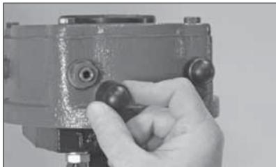
2. Entfernen Sie die sich auf der linken Seite des Antriebs befindliche Staubkappe des Speicherstopps, wie oben dargestellt.
