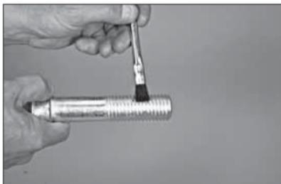
**5. SCHRAUBENGEWINDE SCHMIEREN:** Tragen Sie eine dünne Schicht Victaulic Schmiermittel oder Silikonschmiermittel auf die Schraubengewinde auf. **ANMERKUNG:** Wenn Edelstahlschrauben und -muttern bestellt wurden, tragen Sie Gleitmittel auf die Schraubengewinde auf.
