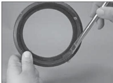
**3. DICHTUNG SCHMIEREN:** Tragen Sie auf die Dichtungslippen und das Äußere der Dichtung eine dünne Schicht Victaulic Schmiermittel oder Silikonschmiermittel auf. Es ist normal, dass die Dichtfläche trüb weiß erscheint, nachdem die Dichtung im Einsatz war.
