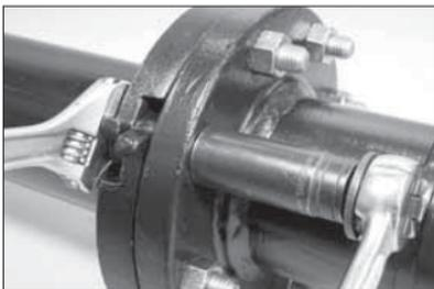
**8. MUTTERN FESTZIEHEN:** Ziehen Sie die Muttern wie bei einer normalen Flanschbaugruppe gleichmäßig fest. Fahren Sie mit dem Festziehen solange fort, bis an den Auflageflächen der Flanche Metall auf Metall trifft oder das empfohlene Drehmoment für Flanschschrauben erreicht ist.
