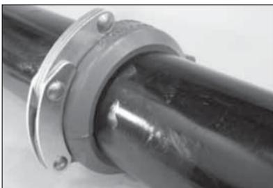
**3a.** Drücken Sie den Verriegelungsgriff fest nach unten, bis die gesamte Griffbaugruppe mit dem Kupplungsgehäuse in Kontakt ist. Die gesamte Griffbaugruppe muss mit dem Kupplungsgehäuse in Kontakt sein, um eine ordnungsgemäß verriegelte Verbindung zu gewährleisten.
