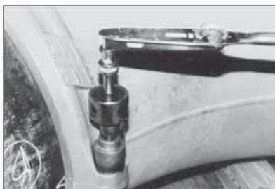
**5. DREHMOMENT AUFBRINGEN:** Bringen Sie mit einem Drehmomentschlüssel auf jede Mutter ein Drehmoment von 600 ft-lbs/ 814 N•m auf. Aufgrund der hohen Drehmomentanforderungen wird die Verwendung eines verzahnten Drehmomentverstärkers empfohlen.
