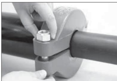
**6. SCHRAUBEN/MUTTERN MONTIEREN:** Montieren Sie die Schrauben und drehen Sie eine Mutter von Hand auf jede Schraube. **ANMERKUNG:** Stellen Sie sicher, dass der ovale Schraubenhals jeder Schraube richtig im jeweiligen Schraubenloch sitzt.
