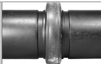
2. **BRINGEN SIE DIE DICHTUNG AN:** Führen Sie das genutete Ende eines Gegenstücks in die Dichtung ein, bis es den Mittelsteg der Dichtung berührt.
