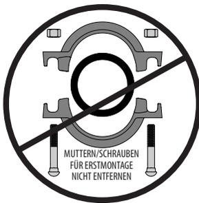
**1. NEHMEN SIE DIE KUPPLUNG NICHT AUSEINANDER:** Die starren QuickVic™ Installation-Ready™ Kupplungen des Typs 107V sind so konzipiert, dass der Monteur die Muttern und Schrauben für die Installation nicht entfernen muss. Dies erleichtert die Installation, da der Monteur das genutete Ende der Gegenstücke direkt in die Kupplung einführen kann, nachdem die Gegenstückenden richtig vorbereitet worden sind.
