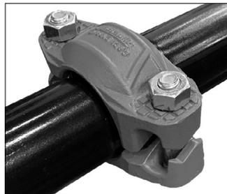
**4. STELLEN SIE DIE VERBINDUNG HER:** Stellen Sie die Verbindung her, indem Sie das genutete Ende eines Gegenstücks in jede Öffnung der Kupplung einführen. Die genuteten Gegenstückenden müssen so weit in die Kupplung eingeführt werden, bis sie mit dem Mittelsteg der Dichtung in Kontakt sind.
