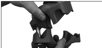
4. **ZUR ERLEICHTERUNG DES WIEDERZUSAMMENBAUS:** Eine Schraube kann mit einer lose auf die Schraube gedrehten Mutter in die Gehäusehälften eingeführt werden, damit die Hälften wie gezeigt um das Rohr gelegt werden können. **HINWEIS:** Die Mutter darf nur so weit gedreht werden, dass sie mit dem Ende der Schraube bündig ist.
