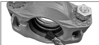
**3c. Bei allen anderen gekennzeichneten Dichtungen einschließlich solchen mit roten und grünen oder orangefarbenen und silberfarbenen Streifen:** Tragen Sie eine dünne Schicht eines verträglichen Schmiermittels nur auf die Dichtlippen der Dichtung auf. Siehe die nachstehende Tabelle „Schmiermittelverträglichkeit von Dichtungen“. **HINWEIS: Es ist nicht notwendig, die Dichtung aus den Gehäusehälften herauszunehmen, um Schmiermittel auf deren äußere Dichtfläche aufzubringen.**
