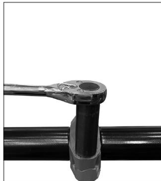
**5. ZIEHEN SIE DIE MUTTERN AN:** Ziehen Sie die Muttern mit einem Schlagschrauber oder Standardsteckschlüssel mit einem langen Einsatz entsprechend einer der auf Seite 4 dargestellten Methoden an. Überschreiten Sie dabei an **KEINER** der Schrauben die in der Tabelle auf Seite 3 aufgeführten Werte für das „maximal zulässige Schraubendrehmoment“. **ANMERKUNG:** Bei Kupplungen mit Etikett an den Auflageflächen darf nur die auf Seite 4 dargestellte Montagemethode 2 (über Kreuz) verwendet werden.
